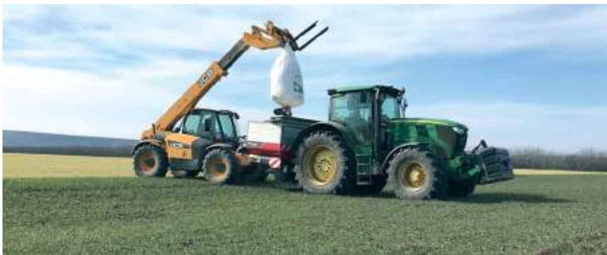
Alimentarea distribuitorului de îngrășăminte pentru fertilizare
