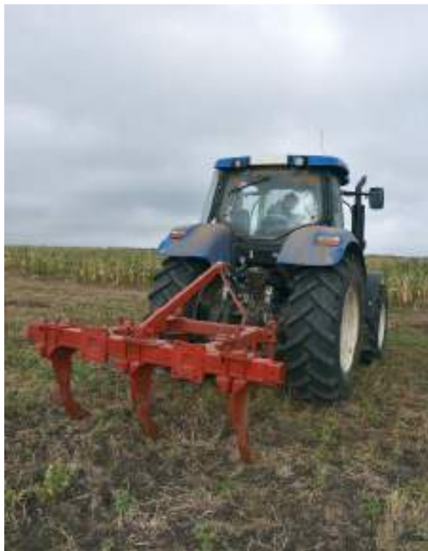
Complex de utilaj pentru TCLS
