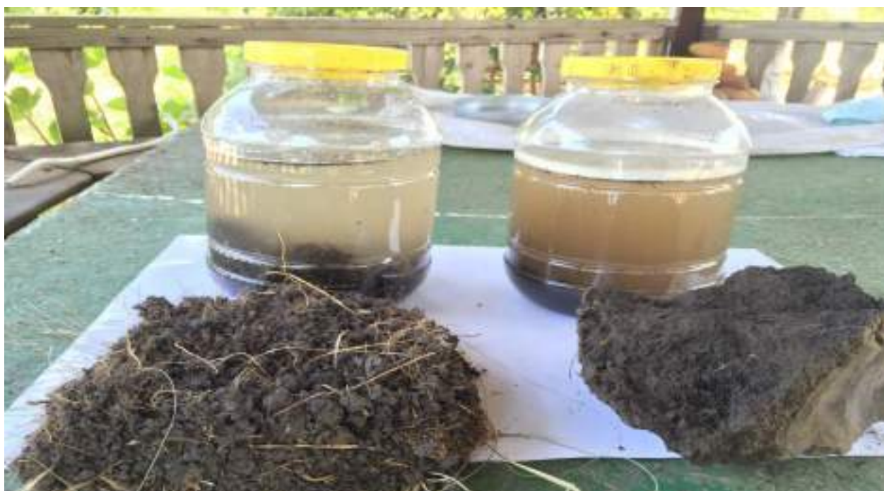
Фото 1.2. Гидростабильность структурных агрегатов в залежи (слева) и в черном пару (справа) после смешивания с водой
