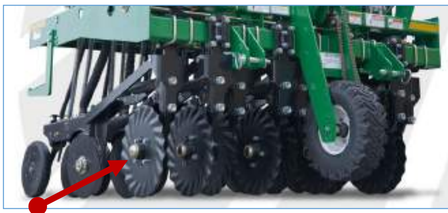
Фото 11.9. Сеялка для зерновых культур с режущим диском перед сошником
