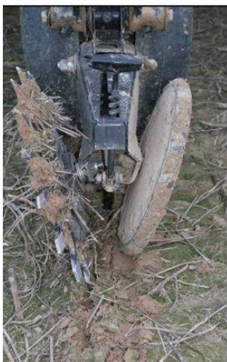
Фото 11.14. Комбинированный комплект прикатывающих колес для лучшего закрытия бороздки
