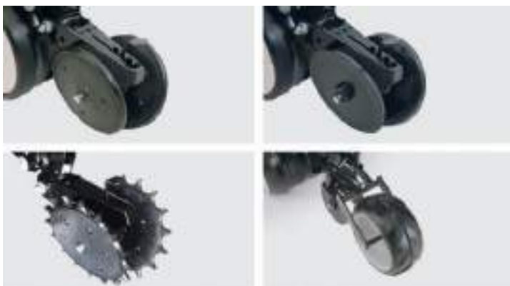
Фото 11.16. Комплекты различных прикатывающих колес, предложенные некоторыми производителями сеялок
