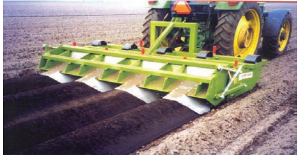
Fig 25. Mașina pentru formarea biloanelor la cultivarea cartofului tip BASELIER
