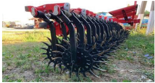
Fig. 89. Grapă rotativă pentru distrugerea crustei și a buruienilor
