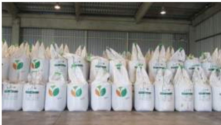
Fig. 54. Stivuirea Big Bags se va face pe palete în stivă de maxim două rânduri dacă depozitarea se face în interior și 1 rând în exterior
