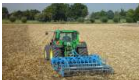
Fig. 39. Lucrarea solului în sistemul conservativ – minimum de lucrări ale solului (Mini Till) după cultura porumbului cu grapă cu discuri
