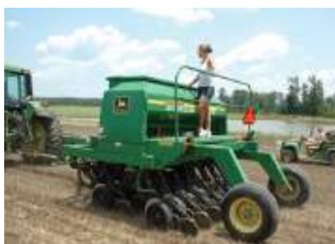
Fig. 46. Semănătoare directă al sistemului conservativ- zero lucrări ale solului (No-Till)
