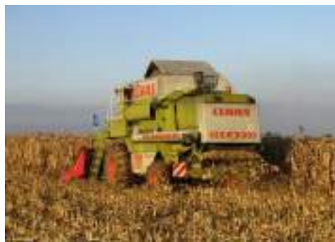
Fig. 45. Combină pentru recoltarea porumbului cu dispozitiv de producere a mulciului vegetal
