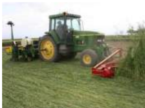
Fig. 52. Desființarea culturii verzi de secară și semănatul porumbului, în aceeași trecere, folosind tehnologia no-till.
