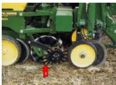
Fig. 47. Organul de lucru a semănătorii No Till – discul pentru deschiderea fantei, aparul de semănat și roțile de tasare
