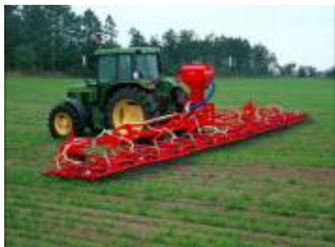
Fig. 59. Cultivarea oarbă cu grapa flexibilă în „faza firelor albe” ale buruienilor
