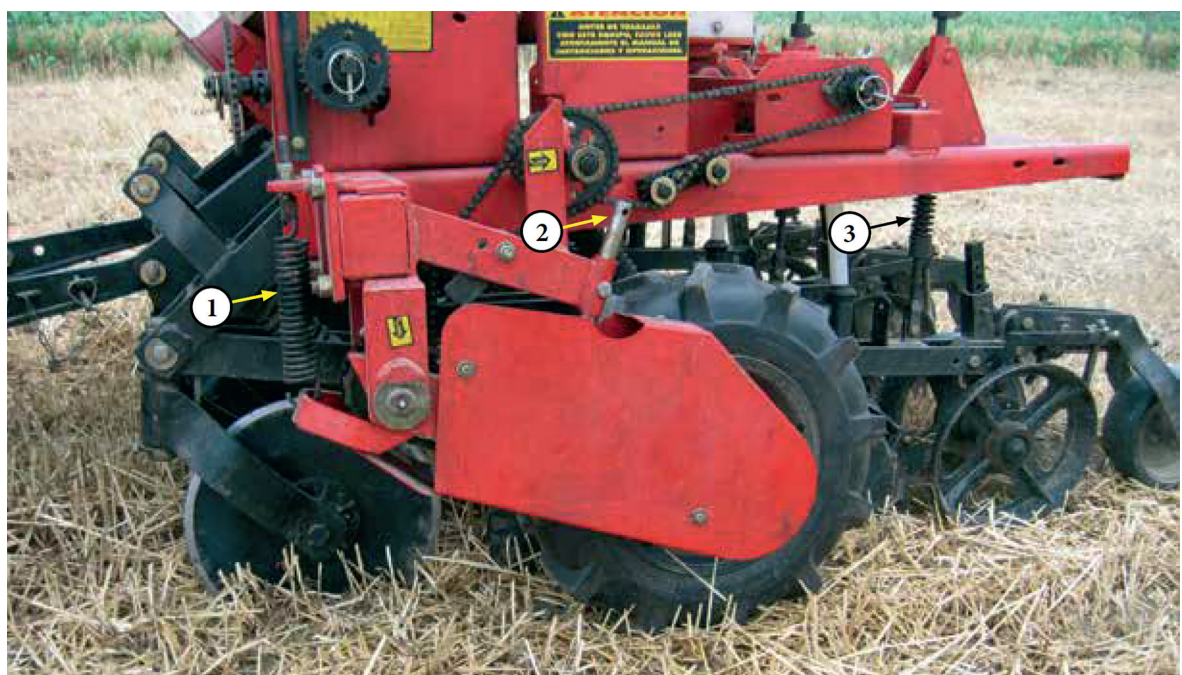
Figura 17. Mecanismul de pătrundere / control al adâncimii: 1. Arc de presiune pentru turbodisc și adâncimea de aplicare a îngrășămintelor; 2. Șurub limitator al roții de antrenare; 3. Arc de presiune pentru adâncimea de semănat.
