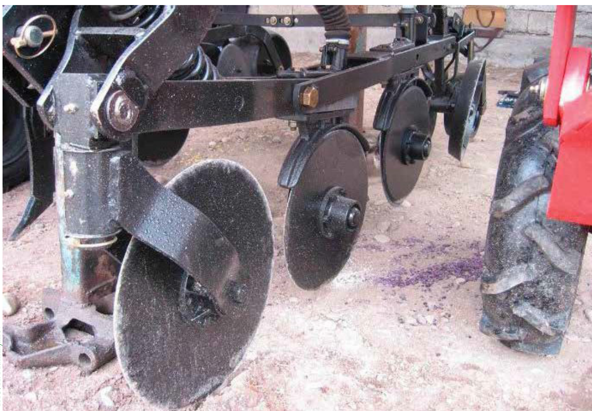
Figura 21. Brăzdare pentru îngurășămintă de tip disc dublu
