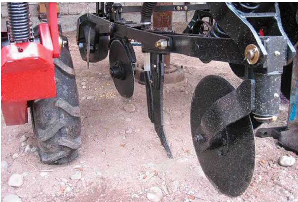
Figura 20. Brăzdare pentru îngurășămintă de tip daltă (chisel)
