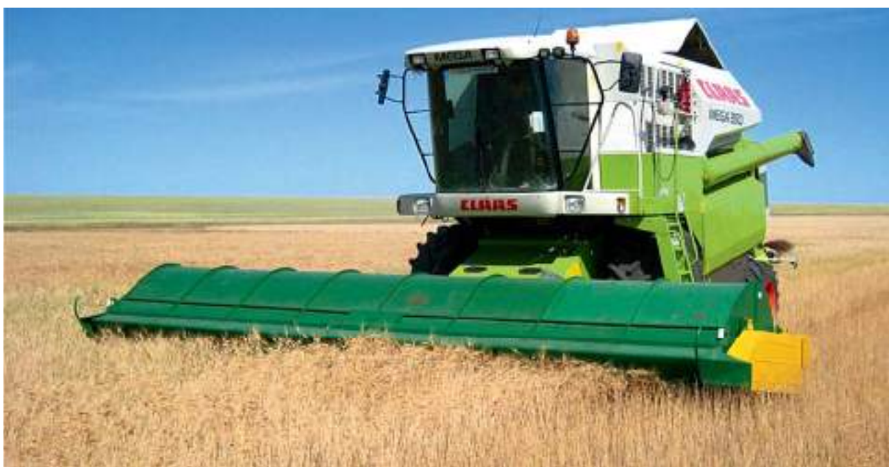
Foto 11.26. Combină echipată cu secerătoarea specială ( stripper header )
