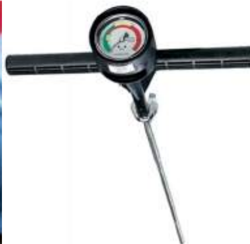
Foto 11.18. Penetrometru pentru determinarea compactării
