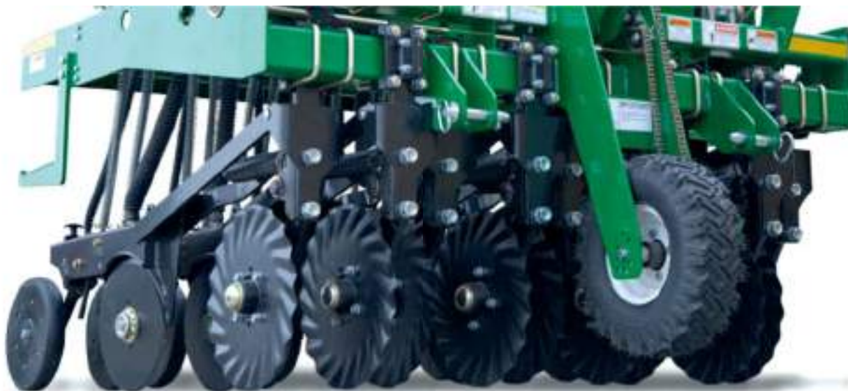
Foto 11.9. Semănătoare pentru culturi cerealiere cu disc tăietor în fața brăzdarului
