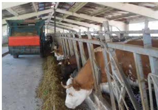
Fig. 2.6. Malaxor utilizat pentru pregătirea și distribuirea amestecurilor unice de furaje
