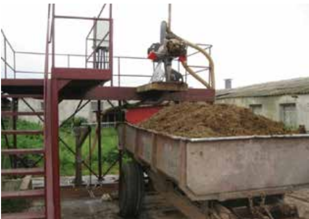
Fig. 3.42. Separarea fracțiilor solide și lichide de dejecții cu separator cu șurub
