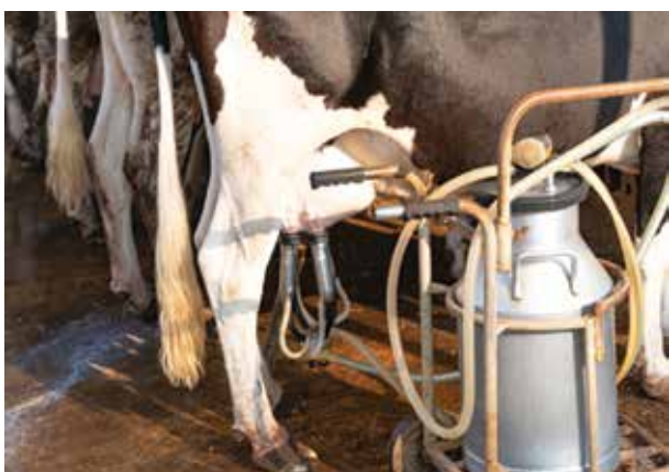
Fig. 3.38. Mulsul mecanizat cu aparat mobil de muls. Sursa: https://www.freepik.com
