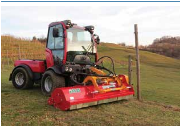
Fig. 2.19. Tractor de curățat pășuni Sursa: www.magazin forestier.ro
