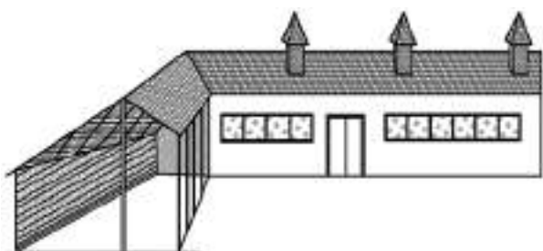
Fig. 4.30. Schema (vedere plană) adăpostului închis cu un șopron lateral (recomandat pentru ferme cu efective de până la 200 oi/capre matcă)
