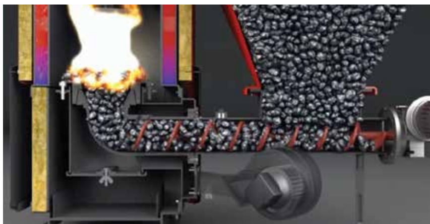
Fig. 2.90. Cazan pe cărbune cu dispozitiv de dozare automată a combustibilului: aspectul exterior al cazanului (dreapta), principiul de lucru al cazanului (stânga).
