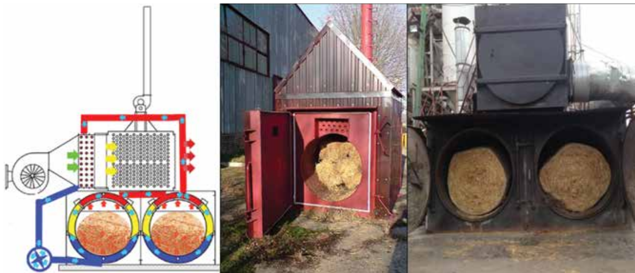
Fig. 2.94. Termocentrala bazată pe arderea paielor: principiul de lucru (stânga), aspectul exterior termocentrală cu o cameră de ardere (centru) și cu 2 camere de ardere (dreapta). Surse: https://fermer24.com.ua și https://semm.ru
