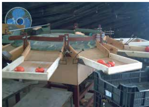
Fig. 2.109. Masă de sortare – calibrarea
