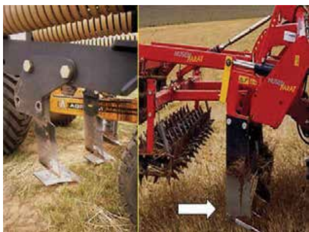
Fig. 2.17. Echipament de lucrare profundă a solului pe verticală
