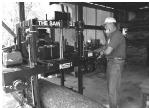
Aplicând un gater cu ramă, Paul procesează lemnul, pe care alții l-ar considera gunoii, transformându-l în produse cu valoare adăugată la ferma sa.
